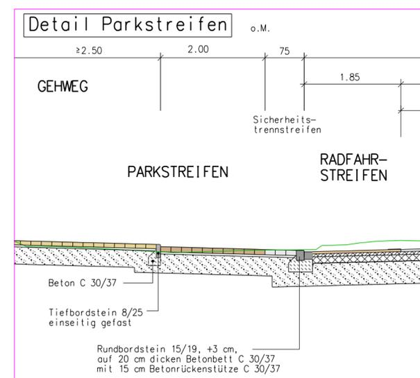
Regelquerschnitt RQ 1 – RQ 1
