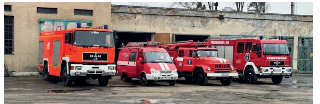
Das Fahrzeug aus Fulda (ein TLF24/50 mit 5000 Litern Wasser und 500 Litern Schaummittelkonzentrat; links im Bild) ist ein echter Gewinn für die Feuerwehrflotte in Iwano-Frankiwsk.
